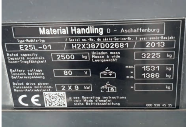
Görsel: Forkliftlerde kullanılan İngilizce ve Türkçe tip etiketleri. Fotoğraflar Erel, 2015: 28-29'dan alınmıştır.
